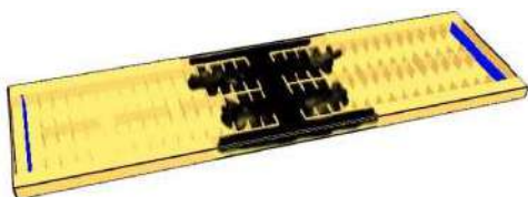
그림 2-11 | FDS 화재 시뮬레이션 모델링에서 사용 가능한 안전한 탈출시간 계산 (ASET=25sec)
