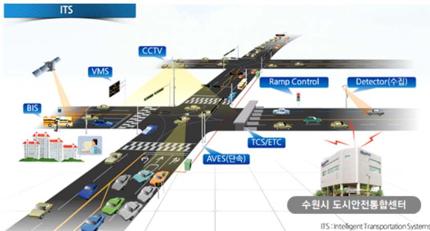
〈그림 5-5〉 수원시 ITS 현황 및 설치 장비
